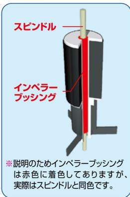
●エココンフォート・シリーズではスピンドルとインペラーブッシング(スピンドルに接する部品)に高品質セラミックを採用、その結果、耐磨耗性が向上し驚異的な耐久性が得られただけでなく、運転音を静寂にしました。
